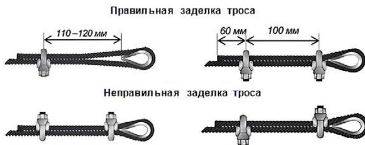
Рисунок 6 – Заделка троса
