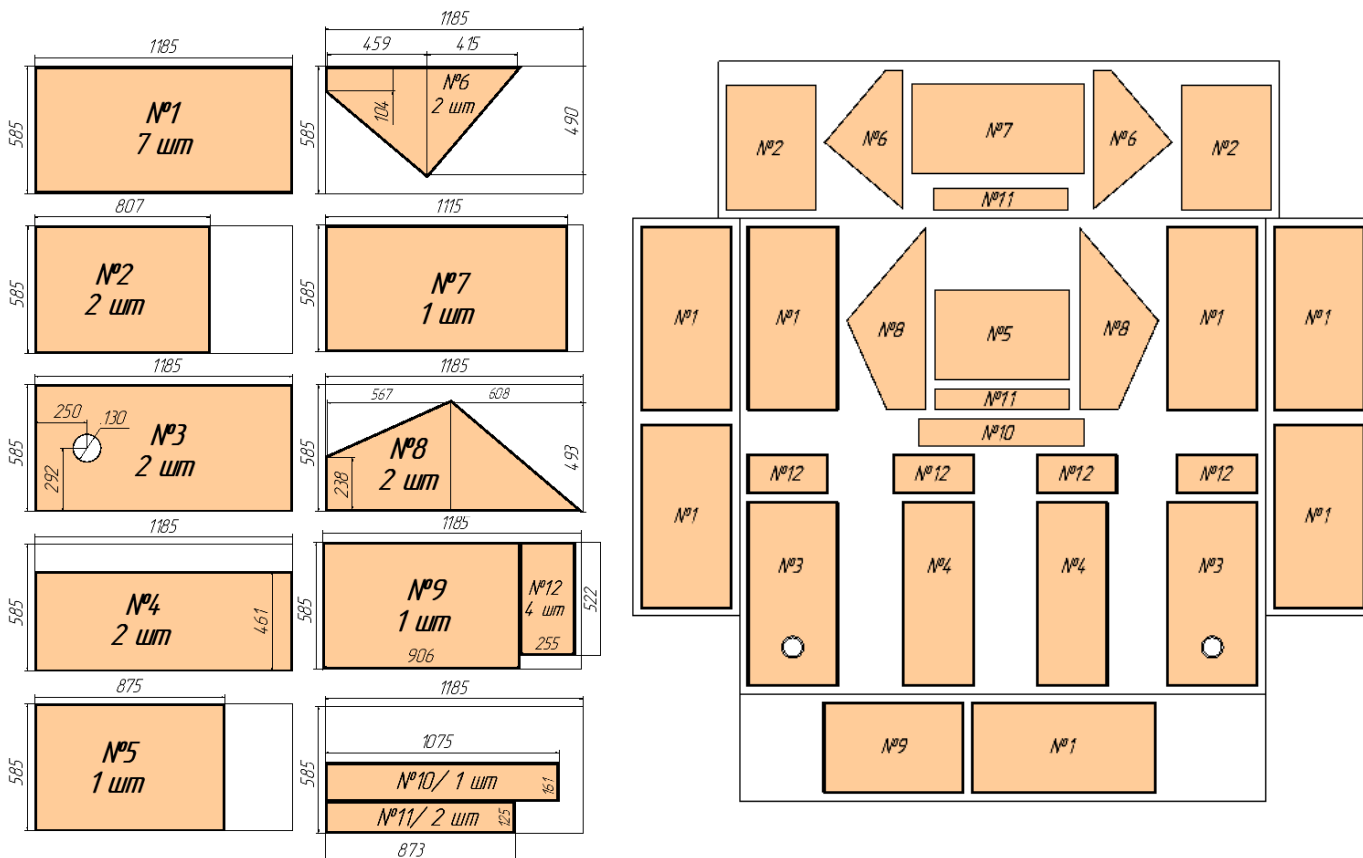
Рисунок 7 – Карта раскроя утеплителя
